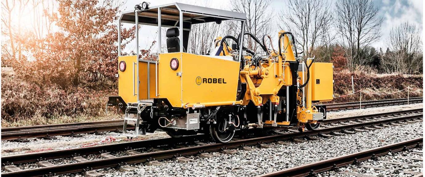
**Kompakte Kleinstopfmaschine zum präzisen Unterstopfen von Gleisabschnitten, die zu groß für manuelle Korrekturen und zu klein für den wirtschaftlichen Einsatz von Großmaschinen sind.**
