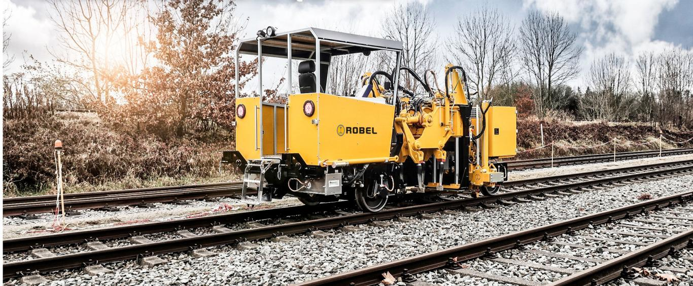
Bourrage précis du ballast pour un confort de circulation assuré. Le compactage du ballast sous les traverses assure une base d'appui stable à la voie et permet de rétablir ou maintenir la qualité géométrique de celle-ci.
