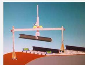
**Pour le levage et le déplacement longitudinal et latéral des rails.**
