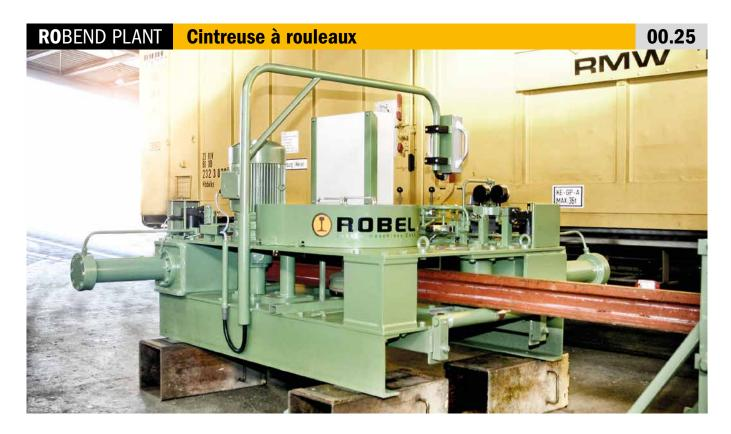
Cintreuse à 4 rouleaux avec réglage hydraulique des rouleaux pour cintrer les rails Vignole et rainurés.
