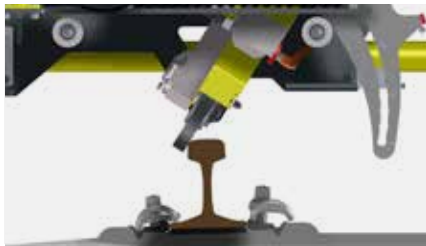
Grinding disc module GX 270
