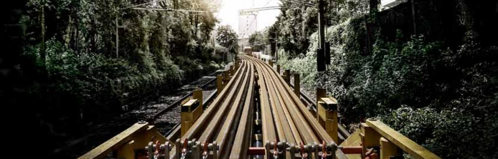
**Das ROREXS System 40.61/63 bringt die Schiene in einwandfreier Qualität auf die Strecke. Der Vorgang des Schienentransportierens und -ladens wird beherrschbar, effizient und sicher.**
