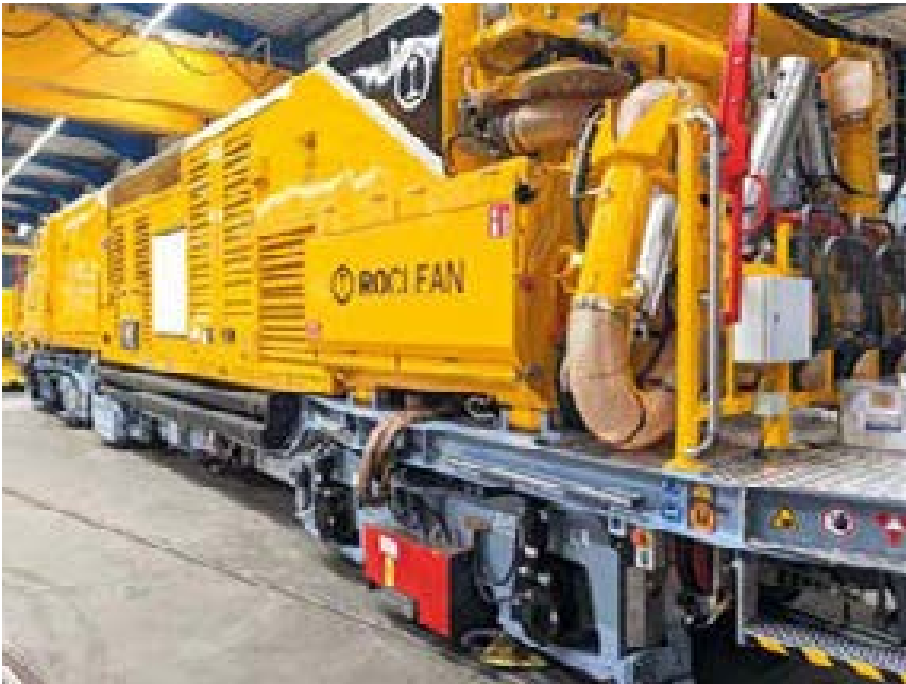
Abb. 8: Zwischen den Einsätzen sind die Schläuche und Verlängerungen in Halterungen gesichert, Bediener und Lotse nutzen die Klappsitze.
