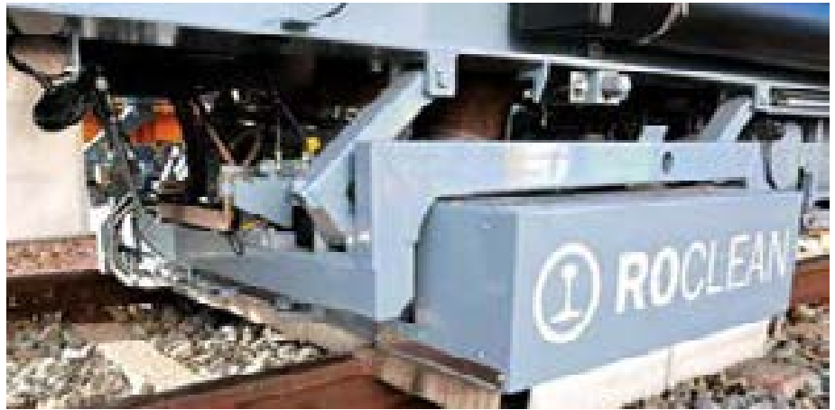
Abb. 3: Während der Fahrt bewegen sich die Blasdüsen des Saugbalkens in Fahrtrichtung und bestreichen die gesamte Oberfläche. Verunreinigungen werden aufgewirbelt und vom Luftstrom der Absauganlage erfasst.
