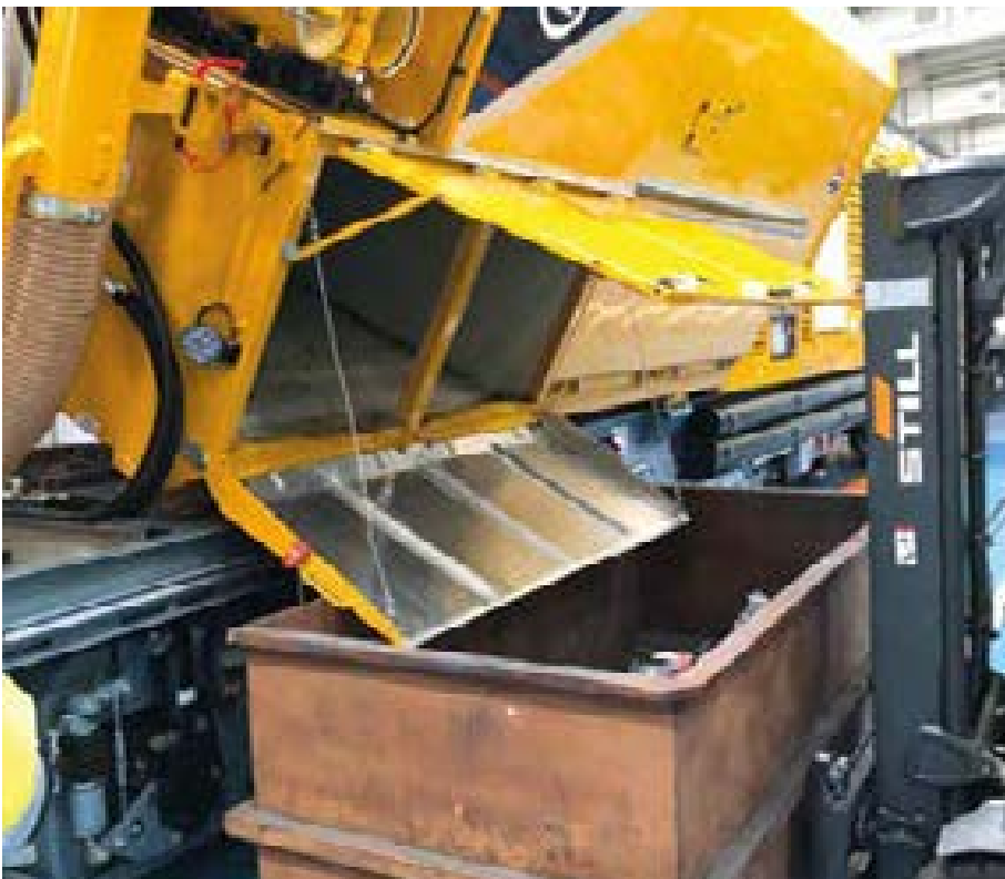
Abb. 9: Die Entleerung der Schmutzbehälter erfolgt durch hydraulisches Abkippen in einen Container.
