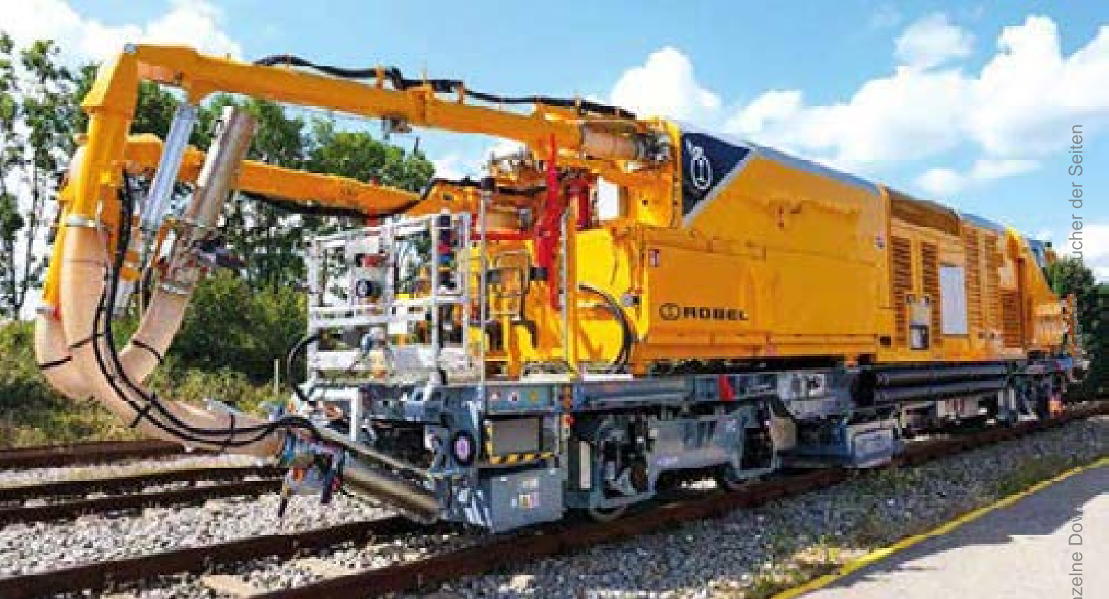
Abb. 1: Das maschinelle Reinigungssystem kombiniert automatisiertes Flächensaugen mit manueller Reinigung durch Saugschläuche.
