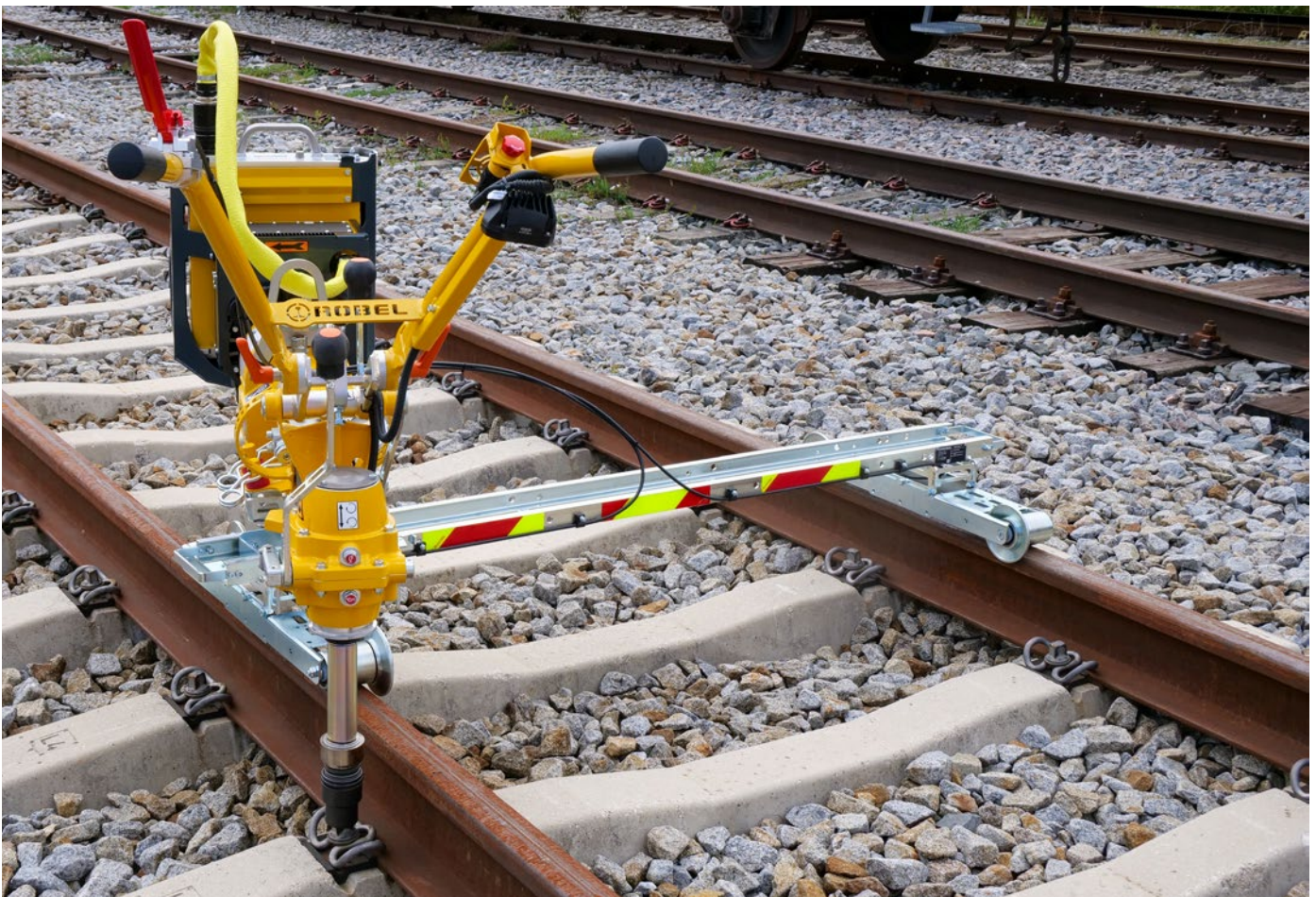
Abb. 7: Das neu entwickelte Querfahrwerk der 30.82 HKS mit Anbindung an den Totmanngriff
