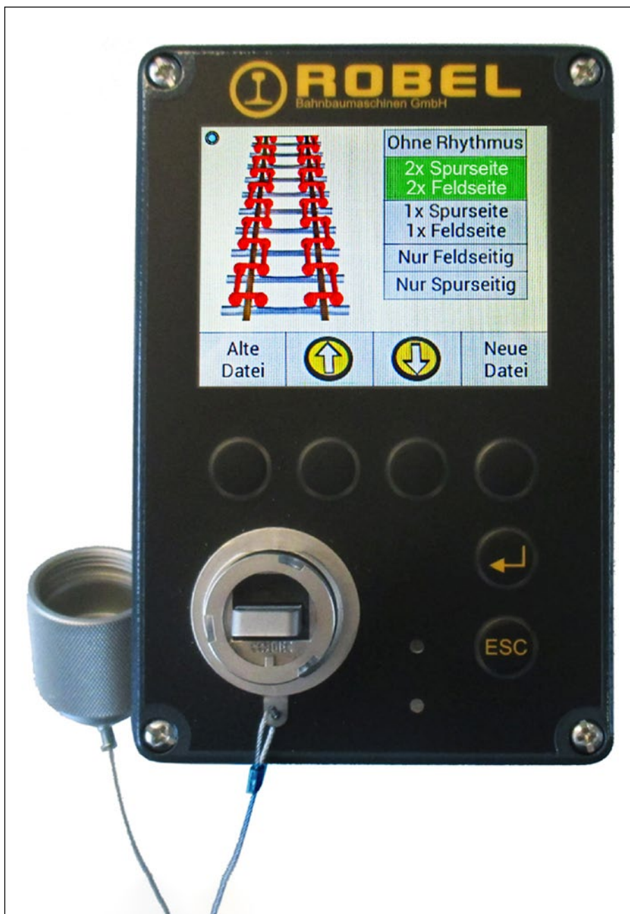
Abb. 4: Das Display zeigt den gewählten Wechselrhythmus feld-/spurseitig und linke/rechte Schiene.
