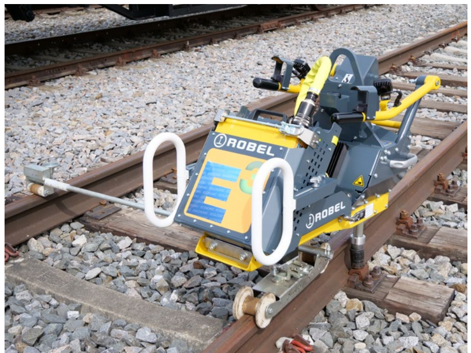
Abb. 3: In Transportstellung passt die Maschine auf eine Europalette.
