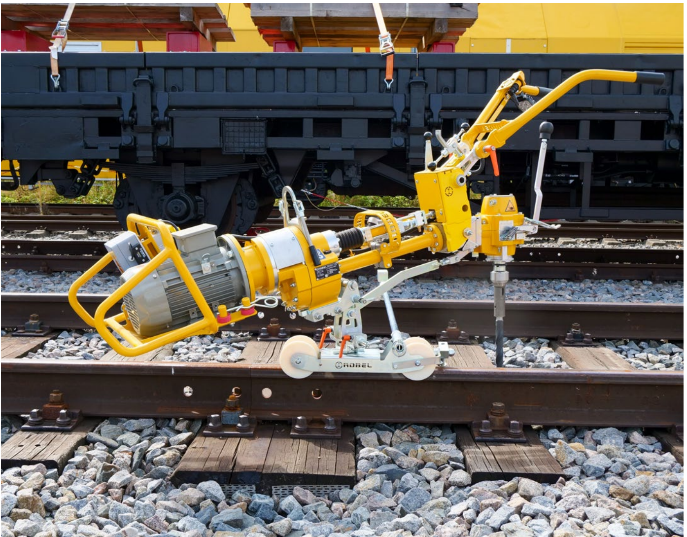
Abb. 9: Durch eine Parallelogrammführung steht das Werkzeug der kombinierten Bohr- und Schraubmaschine 30.83 immer senkrecht.
